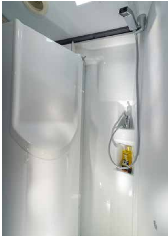
Duplex-kylpyhuoneratkaisussa on kääntyvä seinä tietyissä malleissa.
